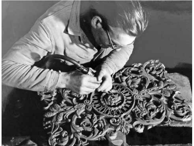
Le ciseleur reproduit un balcon pour les nouvelles travées
